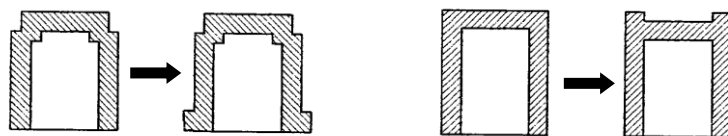
図 2-10 リブによる円筒状成形品の寸法安定化
